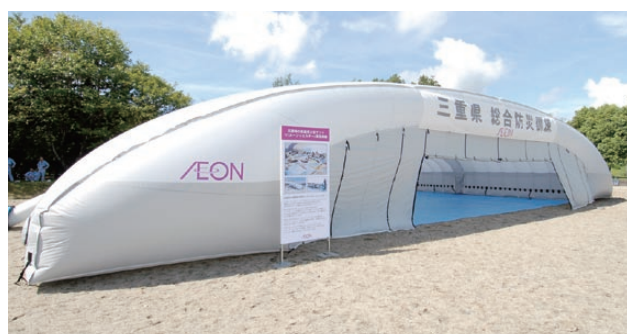
バルーンシェルター 専用の送風機で膨らませるだけで、40分程度で簡単にでき上がり、2基1セットで約100人が横になれる収容能力を持っています。
