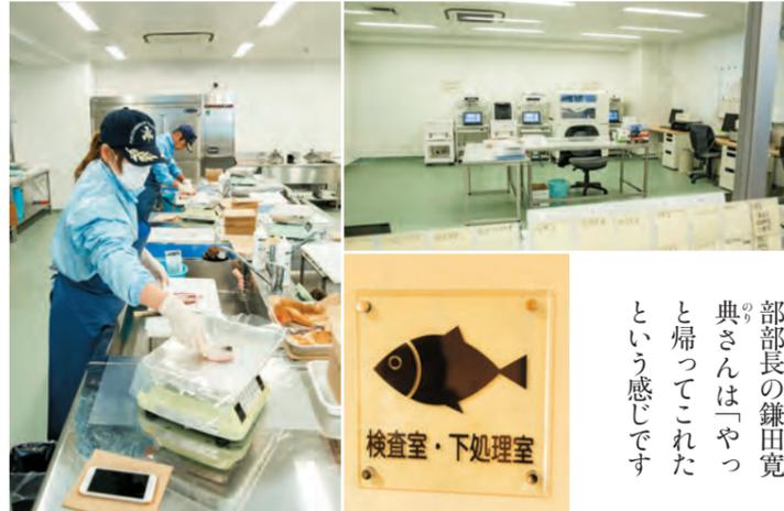
上左/その日取れたすべての魚種で放射性物質の検査を行う 上右/魚種ごとに検査の漏れがないようホワイトボードで作業の進捗を管理 下左/検査できるように魚を三枚下ろしやミンチにする 中右/含有されている放射性物質を測定する機器が9台設置された検査室 下右/魚のアイコンがかわいい検査室・下処理室のパネル
