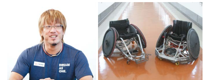
左上／池崎さんが車いすバスケットボールから車いすラグビーに転向したのは30歳の時。そこからわずか3年で日本代表の選手として活躍するようになった 右上／競技用の車いすは攻撃型(右)と守備型(左)の2種類がある。攻撃型は細かい動きができるコンパクトな造り。守備型は突き出したバンパーで相手の車いすを止める
