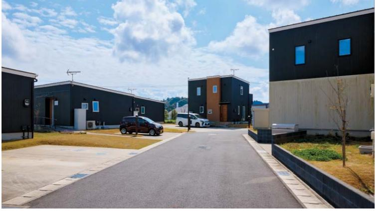
約100人の住民が暮らす住宅エリア。電線はすべて地中化されている。2019年の台風15号では暴風により多くの電柱が倒れ、停電を引き起したが、ここでは地中化が功を奏し被害を免れた。
