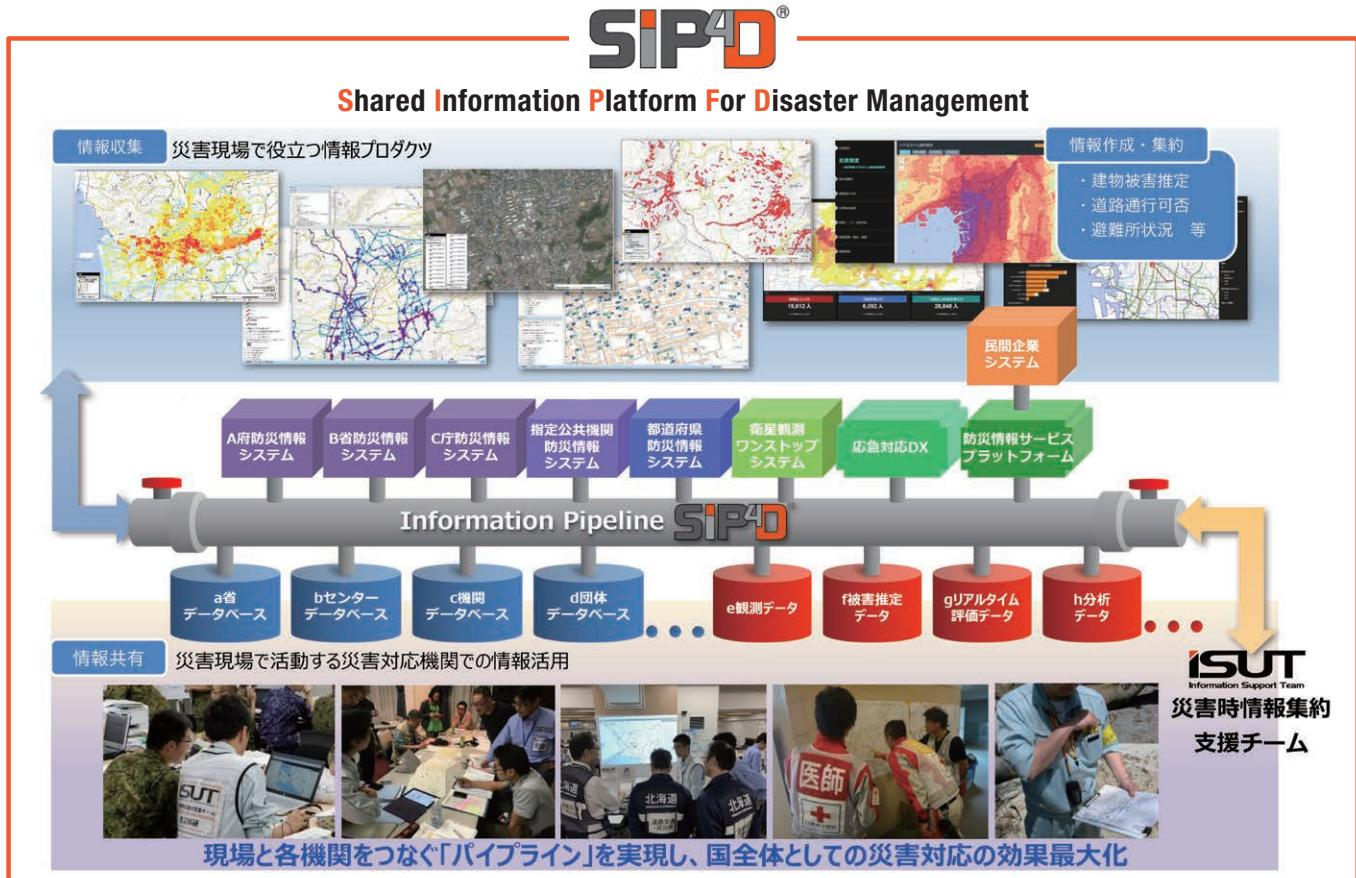
SIP4Dは、すべての災害対応の現場に共通で利用できる防災情報を流通させる情報パイプライン。災害現場に集まる様々な組織が持っている多様な情報を収集し、利用しやすい形式にして配信する。防災情報を、組織を超えて相互に流通させるネットワークシステムだ。
