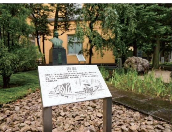
古田さんが主導して設置した大正大学内の雨庭。屋根などに降った雨水を一時的に庭に溜め、ゆっくりと地中に浸透させる
