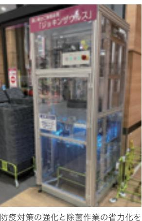
防疫対策の強化と除菌作業の省力化を図る買物かご除菌装置
