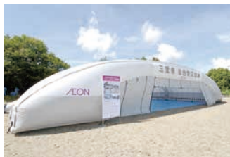
バルーンシェルター 専用の送風機で膨らませるだけで、40分程度で簡単にできあがり、2基1セットで約100人が横になれる収容能力を持っています。
