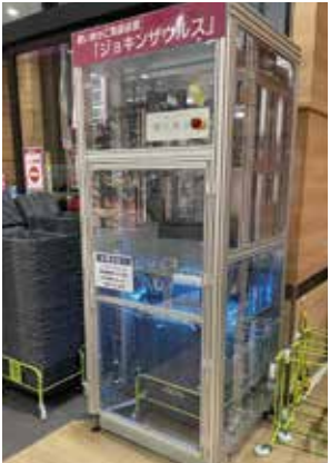
防疫対策の強化と除菌作業の省力化を図る買物かご除菌装置
