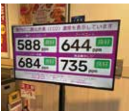
CO2センサーによる換気管理
