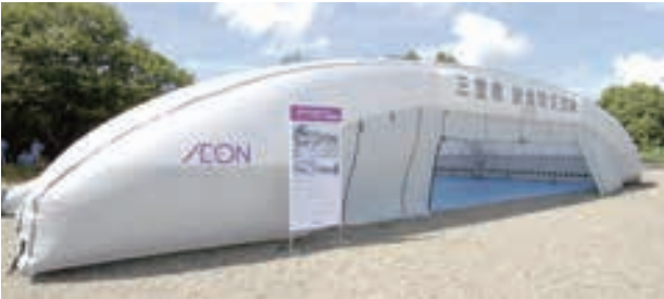
バルーンシェルター 専用の送風機でふくらませるだけで、40分程度で簡単にできあがり、1基で約50人が横になれる収容能力を持っています。
